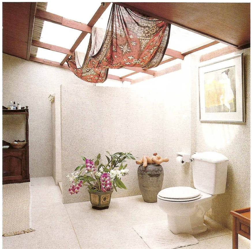
ห้องน้ำใช้หลังคาโปร่งแสงเพื่อนำแสงแดด เข้ามาสู่ภายใน เป็นการฆ่าเชื้อราและ ทำให้ห้องน้ำแห้งเร็วอีกด้วย
